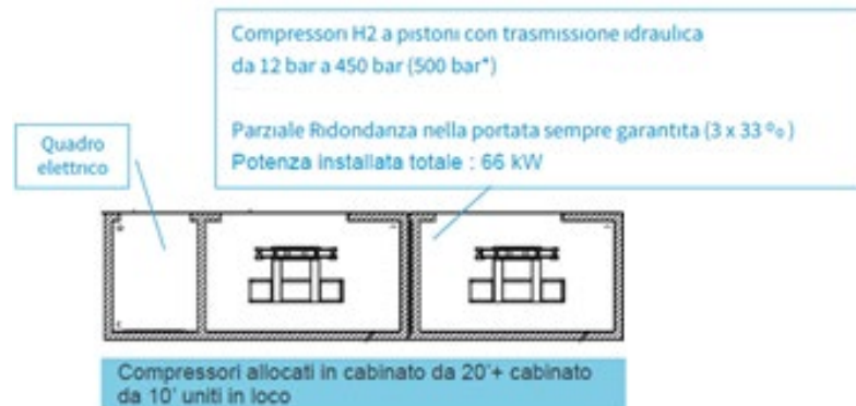
Figura 16. Configurazione tipica del container "compressione"(immagine esemplificativa)
